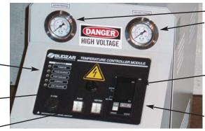
LIQUID-FILLED PUMP SUCTION AND DISCHARGE PRESSURE GAUGES
